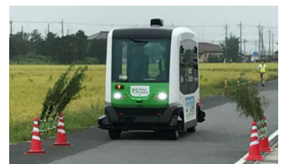
路面の落下物や障害物を再現し、自動運転に必要な道路の管理水準を検証
