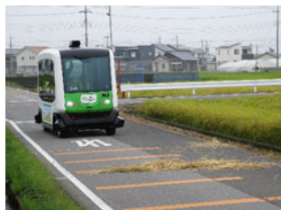
路面の落下物や障害物を再現し、自動運転に必要な道路の管理水準を検証
