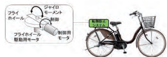
【実用化イメージ】コンパクトな装置を自転車に後付けして使用する
