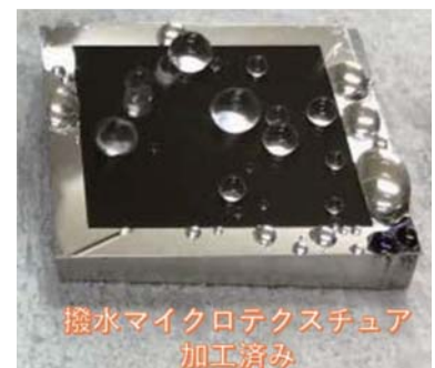
【図3】ステンレス鋼表面の超撥水化により純水に対する接触角度が160°以上となった事例
