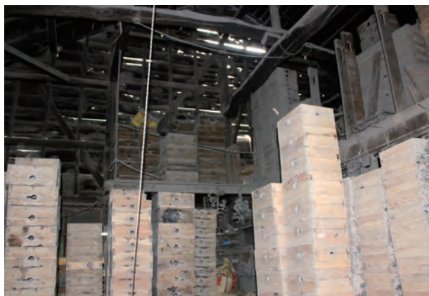
鑄型の保管状況
