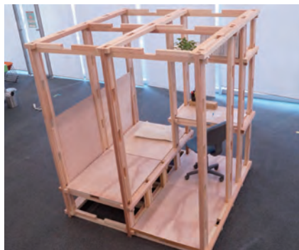
木造インフィルユニットの試作
